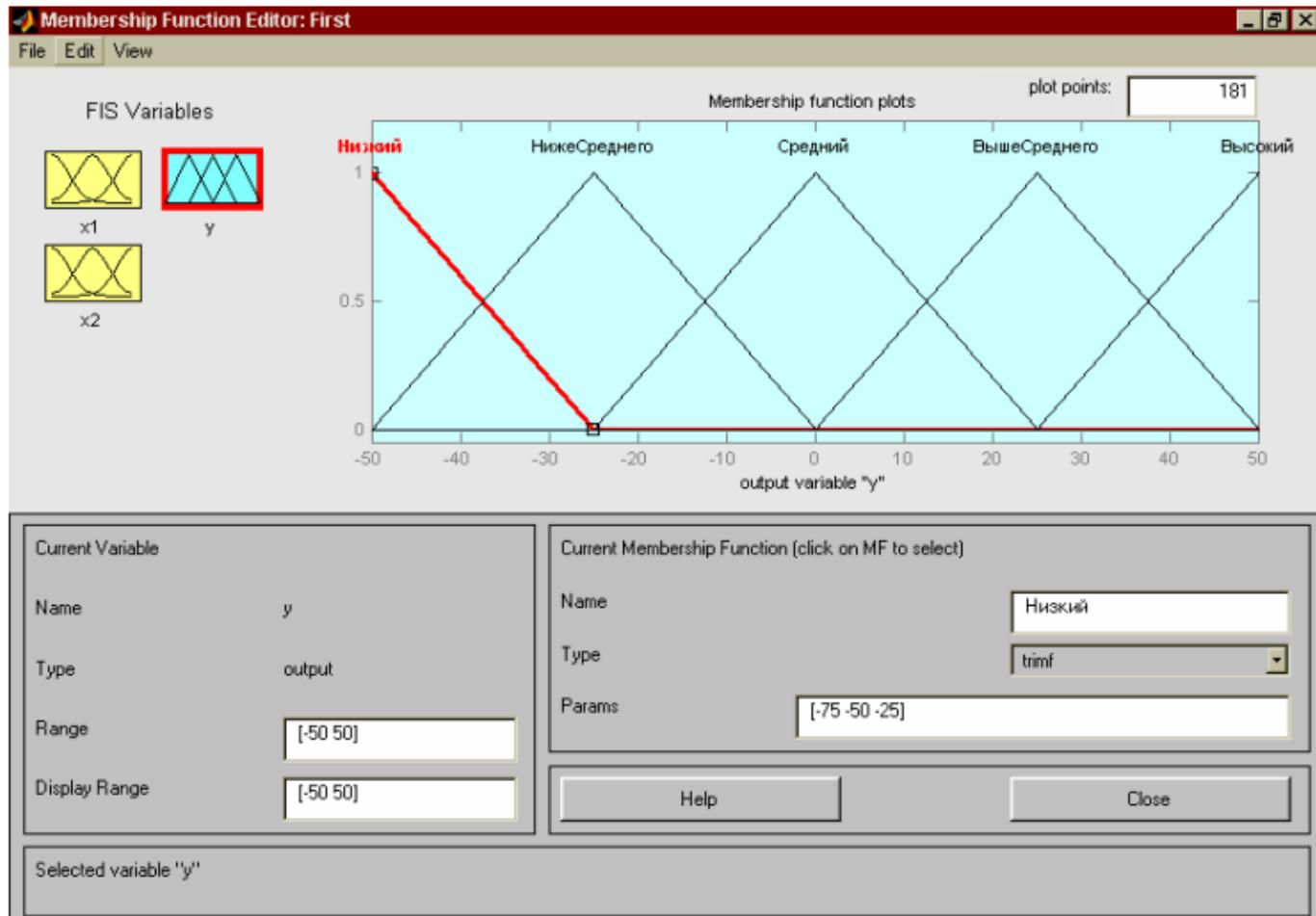
Рис. 5. Функции принадлежности переменной у
