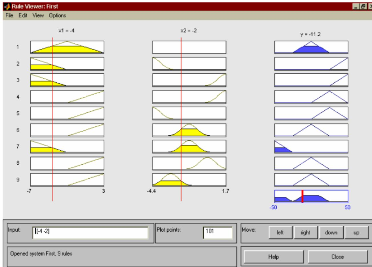
Рис. 7. Визуализация нечеткого логического вывода в RuleViewer
